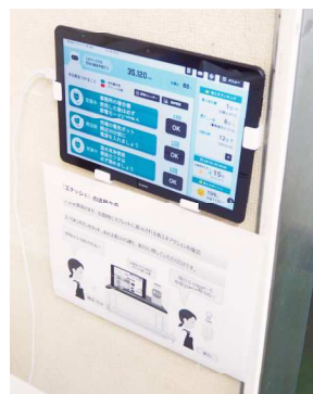
(株)トーホーストアで活用している エネルギーマネジメントシステム
