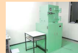
放射性物質を検査する ゲルマニウム半導体検出器
